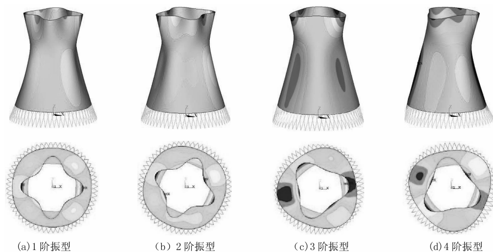
图 2 冷却塔结构前 4 阶振型
