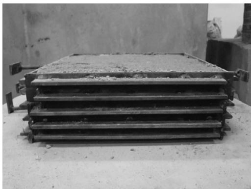
图 2 在叠环中击实的试样
