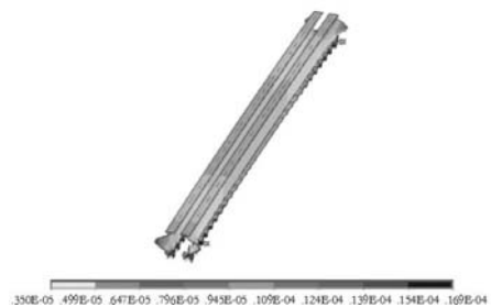
图 6 \pi 型钢板应用于 27 m 梁时 1 阶屈曲模态示意图
