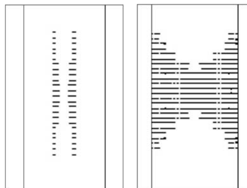
图 3 \pi 型钢板加固 (左) 与粘贴钢板加固 (右) 效果图 (黑色横线为裂缝)
