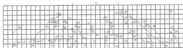
图6(d) HJJ-2 裂缝开展图 Fig 6(d) Crack development figure of HJJ-2
