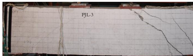
图 7(e) PJJL-3 最终破坏形态 Fig 7(e) Failure modes and crack pattern of PJJL-3
