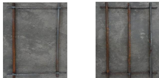
图 2 试验所采用焊接箍筋照片 Fig.2 Welding stirrups photos
