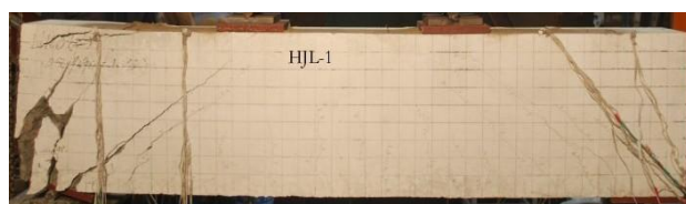
图7(b) HJJ-1 最终破坏形态 Fig 7(b) Failure modes and crack pattern of HJJ-1
