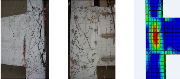
图 2 破坏形态 Fig.2 Failure mode
