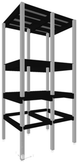
图 5 转运站结构计算模型 Fig.5 The computing model of the transfer station
