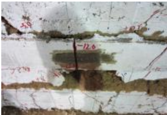
图 7 砂浆带裂缝图 Fig.7 Cracks map of mortar
