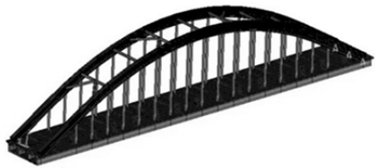
图 2 主桥有限元模型 Fig.2 Finite element model of the main bridge
