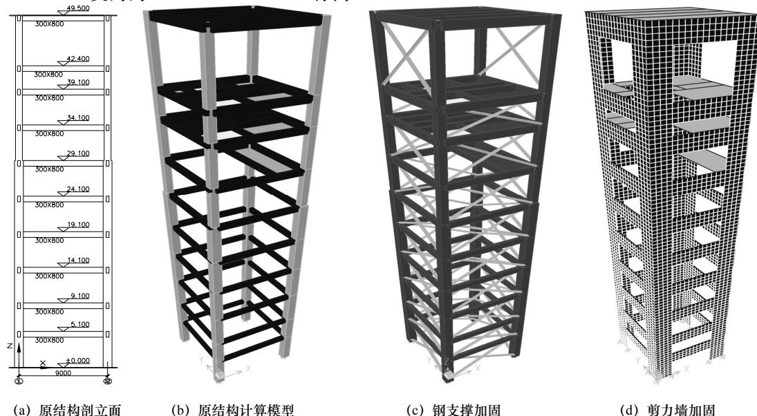
图 2 高层转运站原结构及两种加固方案计算模型
