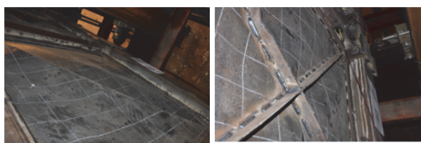
(a) 试件 SPSW-BS (b) 试件 SPSW-DS 图7 钢板墙变形比较
