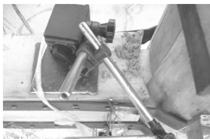
图6 扁钢加固拟静力试验中螺钉拔出
