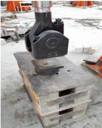
图 1 SMA 金属橡胶元件拟静力试验图 Fig.1 Pseudo-static test of SMA pseudo-rubber metal
