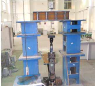
图2 加载装置 Fig.2 The loading device
