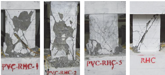
图 2 试件破坏形态 Fig.2 Failure pattern
