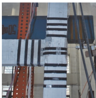
图2 试件加固示意图
