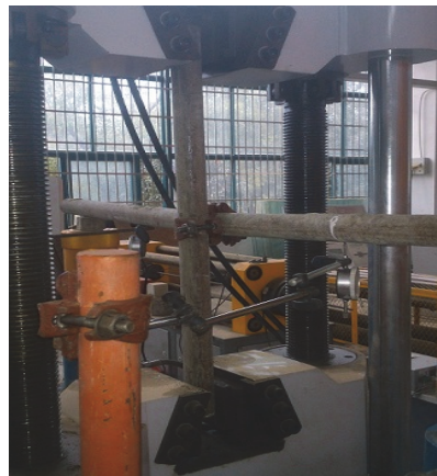
图1 扣件式钢管支撑架连接节点试验装置
