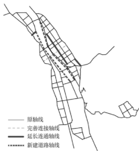
图5 对米脂县城2014版总规路网轴线优化图
