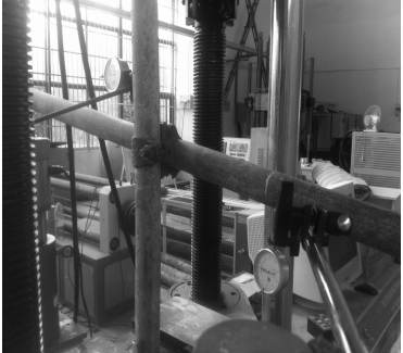
图15 扣件抗扭试验现场图 Fig.15 Fastener torsion test site map
