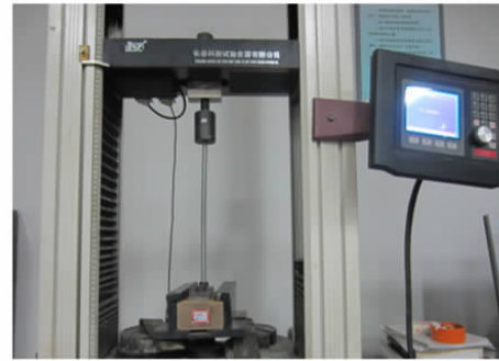
图 1 试验加载装置
