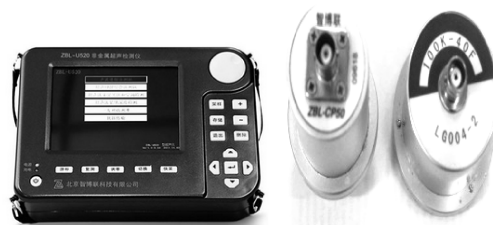
图1 ZBL-U520非金属超声检测仪及换能器
