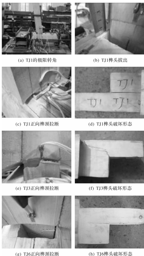
图5 部分试件破坏示意图
