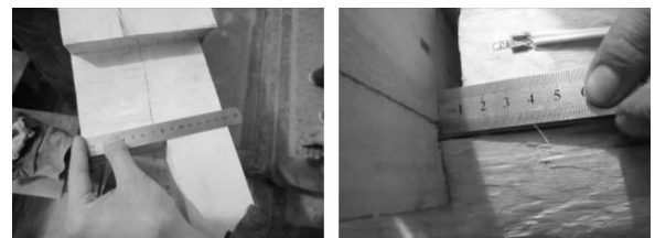
图 2 制作完成的松动榫卯节点(单位: mm)
