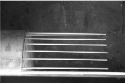
图 2 管棚安装图
