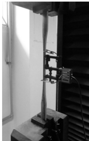
图 3 抗拉弹性模量试验装置
