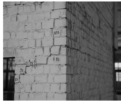
(b) 背立面右侧窗洞口角部裂缝
