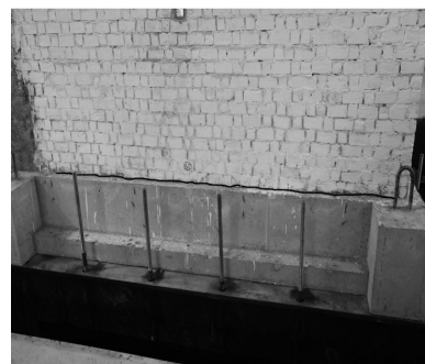
(c) 右立面底部贯通水平裂缝
