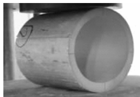
(a) 无竹节环刚度试件破坏形式
