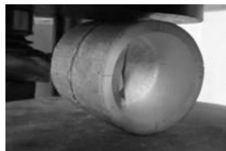
(b) 有竹节环刚度试件破坏形式
