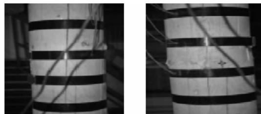
图 6 加固木柱 B4 的破坏过程
