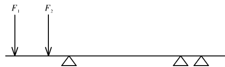
图 6 18# 工字钢承受的集中力示意图 Fig. 6 Schematic diagram of concentrated forces on 18# I-steel
