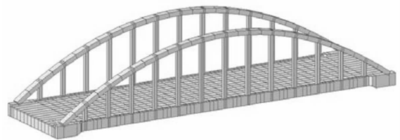
图 2 加固前空间有限元模型
