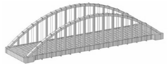
图 3 加固后空间有限元模型
