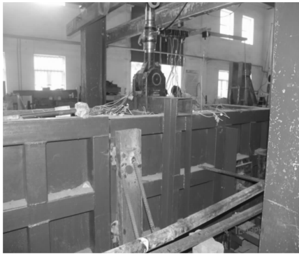
图 3 不均匀沉降下小型埋地管网试验图片 Fig. 3 Test picture of small buried pipe network under uneven subsidence
