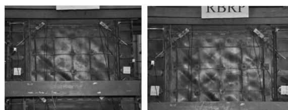
(a) 一层板区格划分及变形 ( 2.5\delta_y ) (b) 3.5\delta_y 第三循环拉方向峰值
