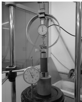
图 1 无侧限抗压强度试验仪
