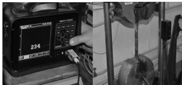
(a) EMS-2003智能磁记忆检测仪 (b) DLY-60型万能材料试验机
