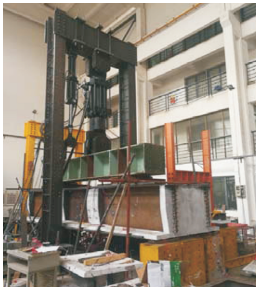
图 11 钢-UHPC 组合“ \pi ”形梁墩顶负弯矩区现浇接缝模型试验
