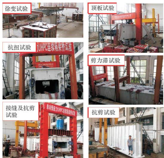
图4 装配式UHPC箱梁试验
