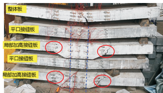
图8 UHPC桥面板湿接缝试验
