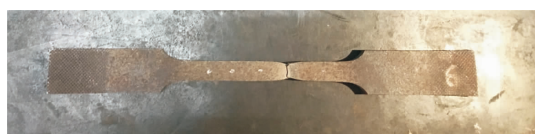
图 10 S-6 件断裂位置
