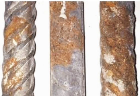
图 4 钢筋锈蚀情况
