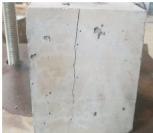
图 8 剪切破坏形态
