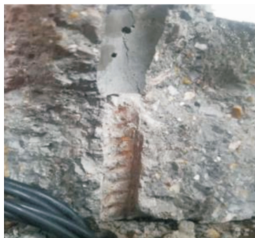
图 7 劈裂破坏形态
