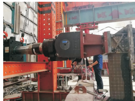
图 2 MTS 液压伺服试验机
