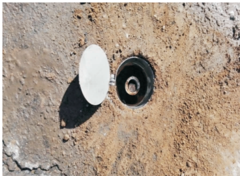
图 9 地表沉降点的钻孔实物图
