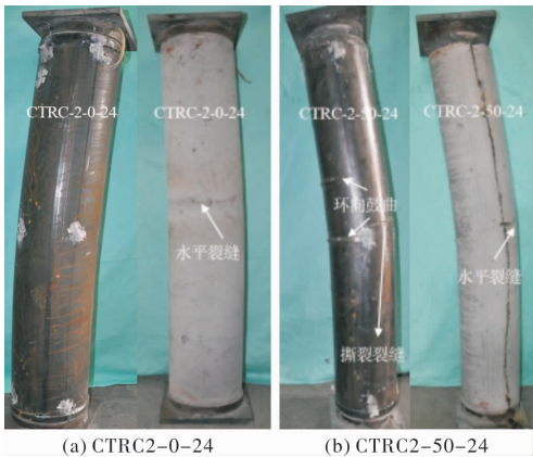
图 6 中长柱破坏模式
