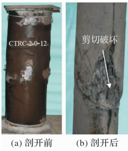
图 4 轴心受压短柱破坏形态
