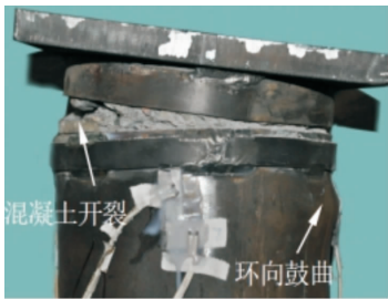
图 7 偏心受压柱端部破坏
