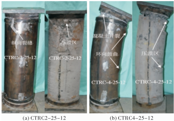
图 5 偏心受压短柱破坏模式
