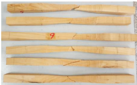
图 11 抗拉试验典型破坏形态
