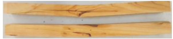
图 16 柏木抗弯试验典型破坏形态 Fig. 16 Typical failure mode of bending tensile test specimen 示 4 种不同使用年限柏木的弯曲抗拉强度试验荷载-位移关系曲线表明, 10 a 柏木弯曲抗拉极限荷载最大, 40 a 次之, 80 a 最小. 表 3 和图 18 所示不同使用年限柏木弯曲抗拉强度值表明: 与柏木的顺纹抗拉强度类似, 10 a 的柏木弯曲抗拉强度最高, 为 197.68 MPa, 80 a 的柏木弯曲抗拉强度最低, 为 101 MPa. 10 a 的柏木抗弯强度比 1 a 柏木的抗弯强度高 75.2%, 40 a 柏木弯曲抗拉强度较 10 a 柏木的弯曲抗拉强度低 22.8%, 80 a 的柏木弯曲抗拉强度较 10 a 柏木的弯曲抗拉强度低 48.9%. 随着使用年限的增长, 在一定年限内, 弯曲抗拉强度有所提高, 到一定年限后之后逐渐降低.
