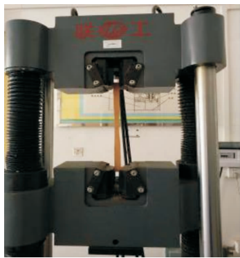
图 10 柏木的抗拉试验
