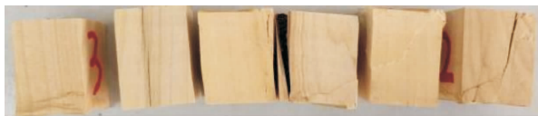
图 6 抗压试验试样典型破坏形态
