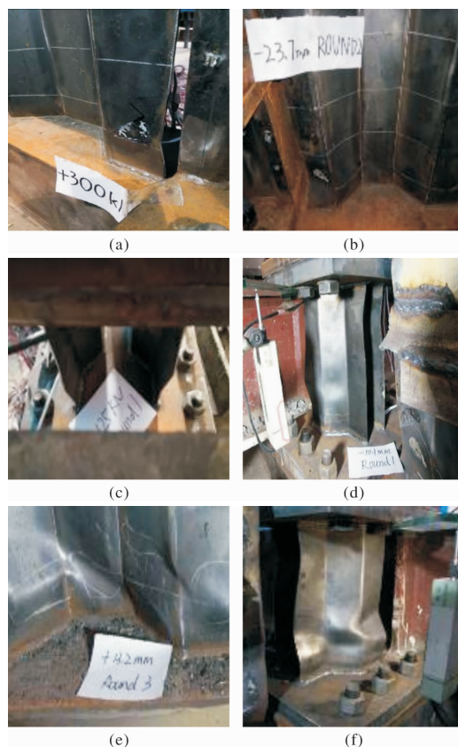
图 6 新型剪力墙试件的破坏形态
