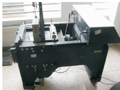
图1 大型界面直剪仪
