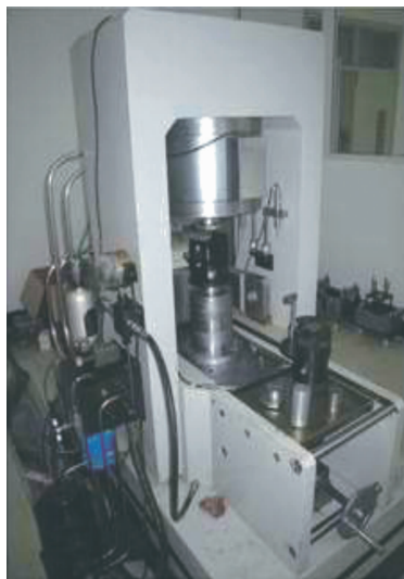
图 1 RMT-150C 岩石力学试验系统
