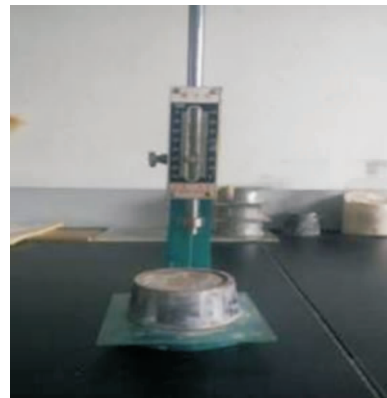
图 7 维卡仪测定水泥凝结时间
