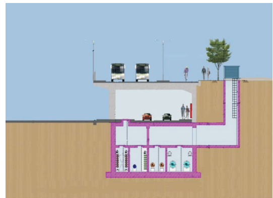
图 6 郑东新区地下空间设计断面
