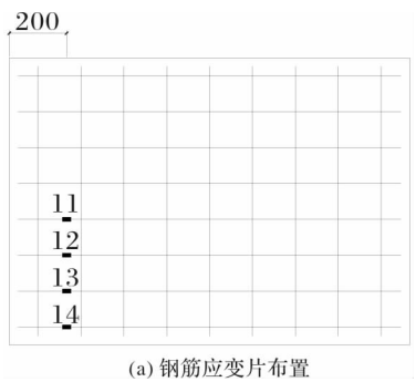
(a) 钢筋应变片布置
