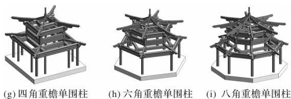
图7 攒尖亭参数化设计结果
