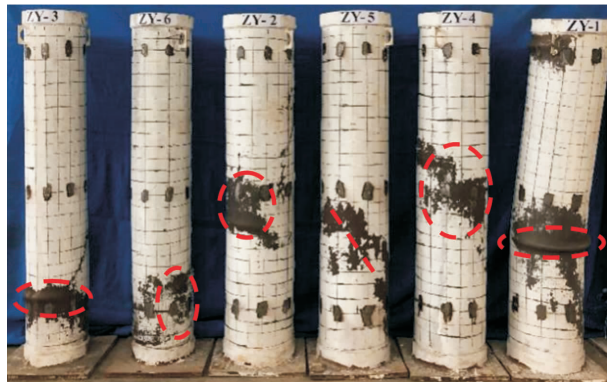
图5 试验试件破坏形态
