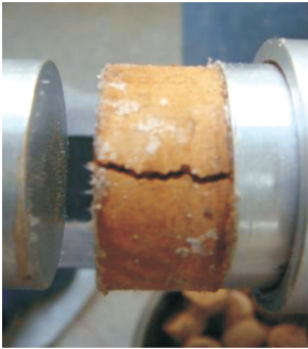
图 4 加载后试样
