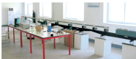
(a) SHPB试验系统实物
