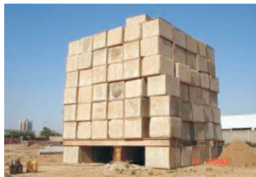
图 1 静载试验装置示意图
