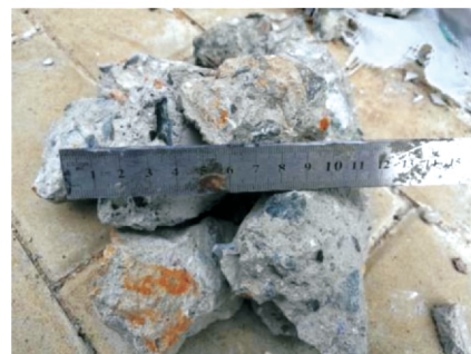
图 1 再生大骨料块体( 60\pm 5 mm)
